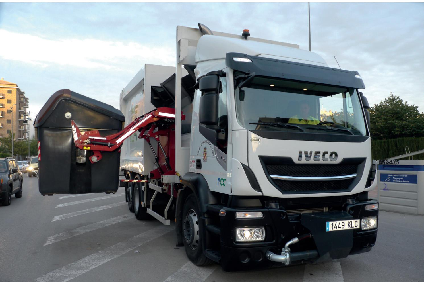
Como mejora, FCC introduce un sistema de recogida de residuos de carga lateral en sustitución de gran parte del sistema actual de carga trasera.
